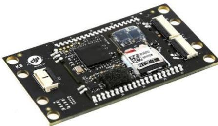
Fig.2 : AHRS inside Phantom4<sup>[2]</sup>
