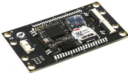
第2図: Phantom4 内蔵 AHRS [2]
